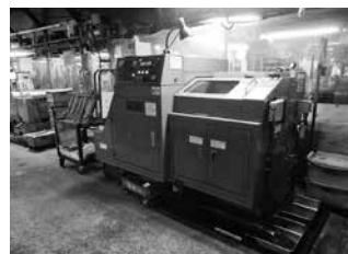
導入設備 (ヘッダーマシン)
