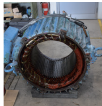
モーター修理
