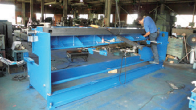
MDH16-4000型動力切断機(組立製作中)
