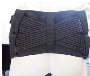
完成したアシストスーツ。交差した8本の組紐の束が人工筋肉
