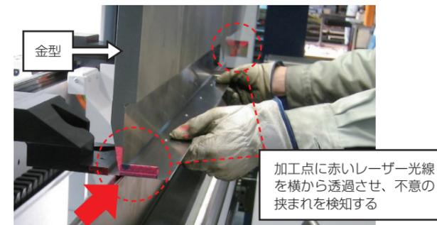
レーザー式安全装置
