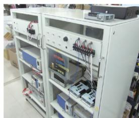
リチウムイオン電池充放電制御システム
