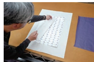
手順1 模様を印刷した転写紙（下）に生地をセット
