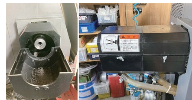
長い材料の回転ブレを防ぐための治具（左が中身、右が外観）
