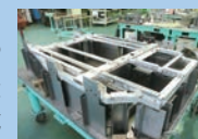
電気自動車アルミフレーム
