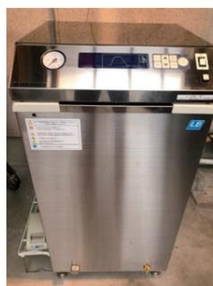
小型レトルト釜。1回70分で60パックの高温殺菌処理ができる。
