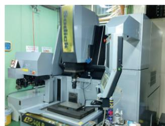
導入した形彫り放電加工機
