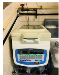
真空包装機。同時に2パック、真空度95%の完成度の高い包装ができる。
