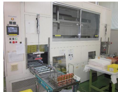
導入した昇降台車式洗浄機
