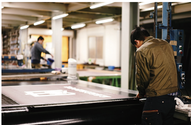
大型の機械捺染による染色工程
