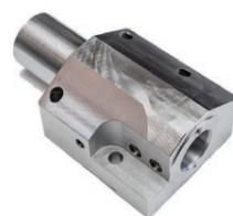
図3 傾斜面加工の一例
